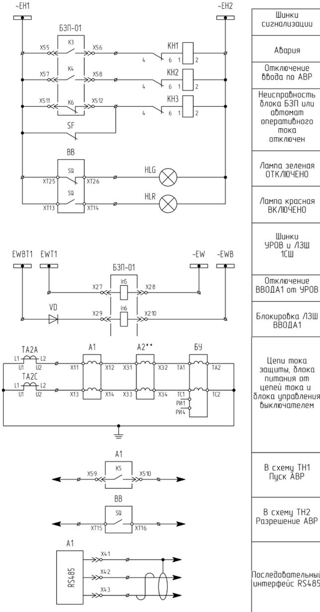
**Рисунок К.1** – Пример использования ВВ и БУ совместно с блоком микропроцессорной релейной защиты БЗП-01
