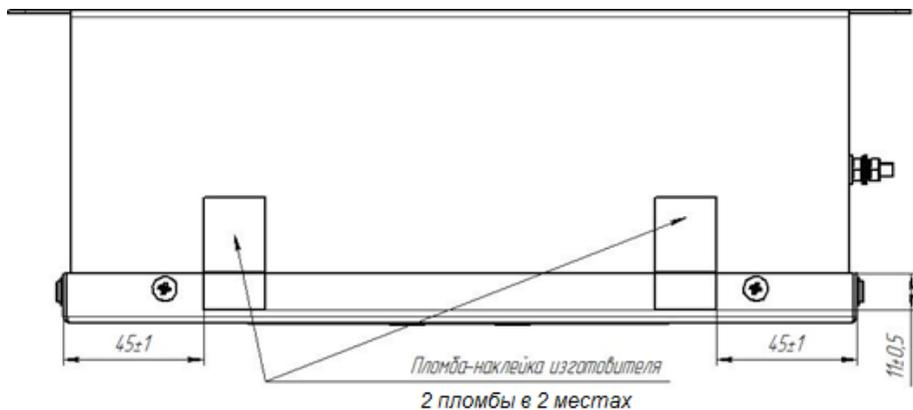
Выступление края пломб-наклеек изготовителя за край крышки не допускается
